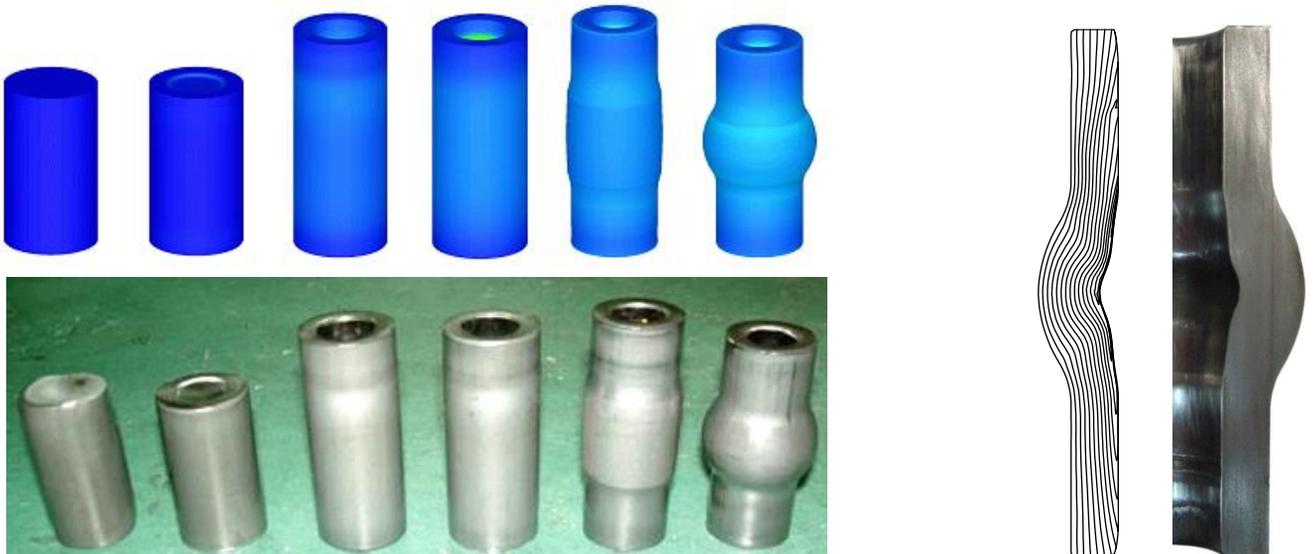
Die Abbildungen zeigen einen Vergleich der prognostizierten Ergebnisse mit Versuchsergebnissen eines automatischen fünfstufigen Kaltumformprozesses. Es ist zu beachten, dass die Simulation von automatischen mehrstufigen Schmiedeprozessen (auch als Umformprozesse bezeichnet) durch entsprechende Fähigkeiten AFDEX unterstützt werden sollte, da ihre aufeinanderfolgenden Stufen eng miteinander verbunden sind und die Toleranz zwischen Gesenk und Werkstück in jeder Phase sehr eng gewählt ist.
