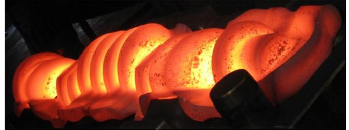
Für einen Hammerschmiedeprozess in einem Schiffsmotor wurde eine gekoppelte Analyse von Temperatur und Verformung durchgeführt, wobei die erforderliche Schlagzahl bei der Gegenschlaghammer-Schmiedemaschine mittels Simulation ermittelt wurde.
